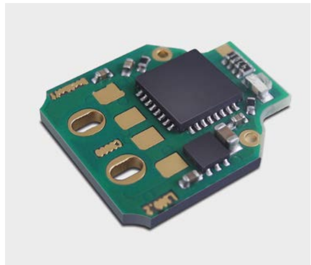
Präzise Schnitte zum Trennen von Leiterplatten, Bohrungen oder nicht-runde Aperturen – das erledigt der Laser in einem Bearbeitungsschritt (Quelle: Smyczek GmbH).
